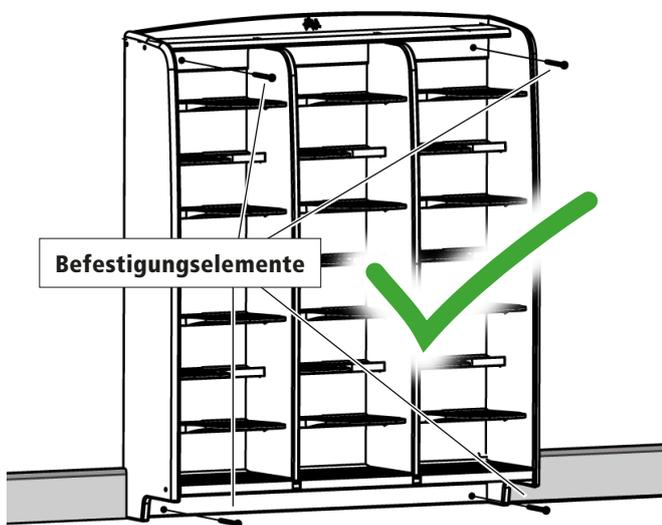
Ein Stück der Sockelleiste entfernen, um das Möbel zu montieren.
