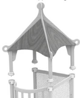
Schrauben Sie eine Kappe auf jeden Pfosten sobald alle Paneele der oberen Ebene eingefügt sind. Drehen Sie sie fest, damit die Kinder sie nicht aufschrauben können.
