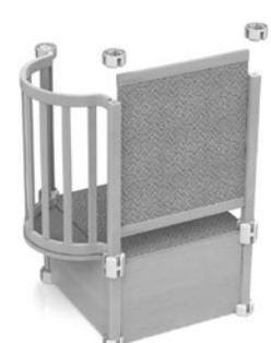
Sobald der Brücken-Unterbau angebracht ist, können Sie die Brückenoberfläche daraufsetzen. Montieren Sie die Brückengeländer mit dem Logo nach außen.
