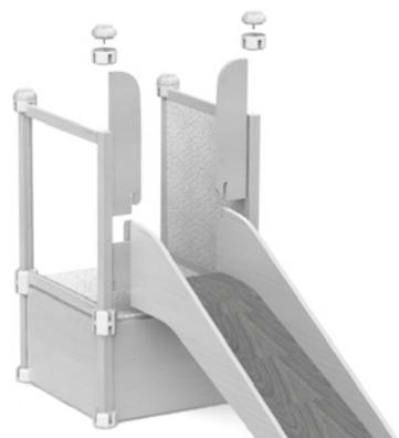
Schieben Sie die Sperre über die Handgriffe für die Rutsche, um diese abzusperrern. Die Sperre kann entweder nach innen oder nach außen zeigen. Bei der Verwendung unter einem Dach sollten die Führungsschienen der Sperre zur Plattform zeigen.
